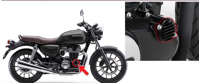
空冷フィンデザインしたオイルフィルターカバーをアルミ削り出しでワンポイントドレスアップ
